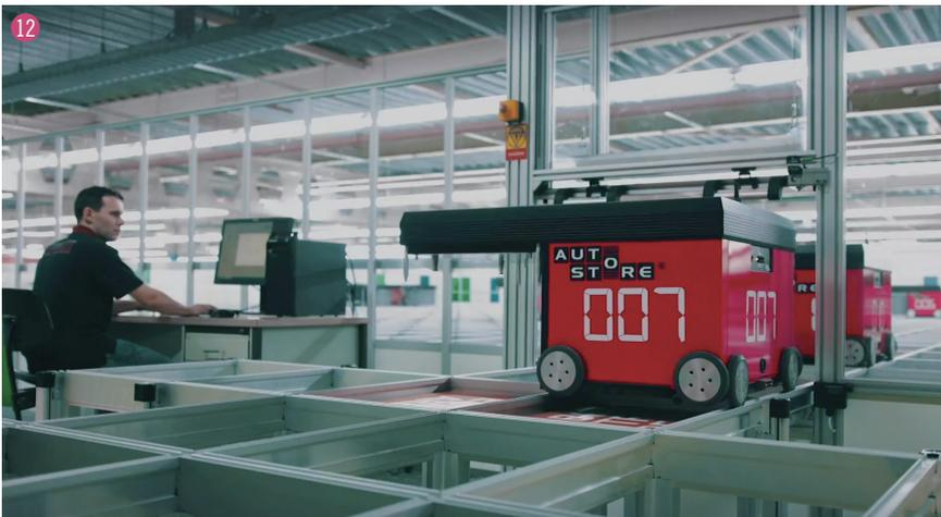
⑨専用コンテナ「ビン」を隙間なく並べ、積み上げて商品を受納 ⑩入出庫や補充作業を行うワークステーション ⑪床が平面であれば、建物の形状を問わず導入が可能 ⑫処理能力を高めるためにロボットの追加も可能
