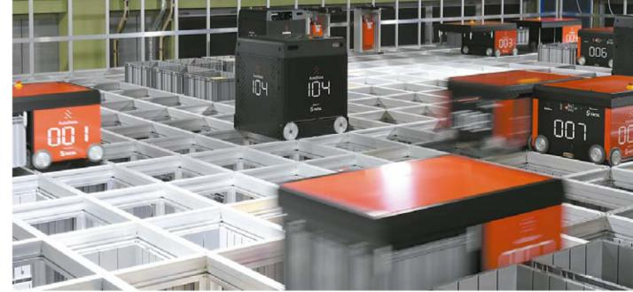
コンテナを隙間なく積み上げて収納することで、従来活用できていなかった天井までの空間を保管スペースとして活用。平置き棚の約3~4倍の超高密度保管を実現可能。
