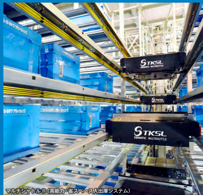
マルチシャトルR (高能力・省スペース入出庫システム)
